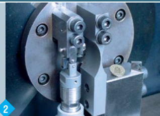
Оснастка для предварительного выращивания трещины на компактных образцах
