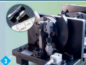
Специализированная оснастка для испытаний на усталость игл клапанов
